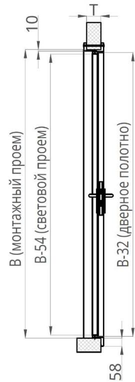
Рисунок 24. Разрез 4-4.
