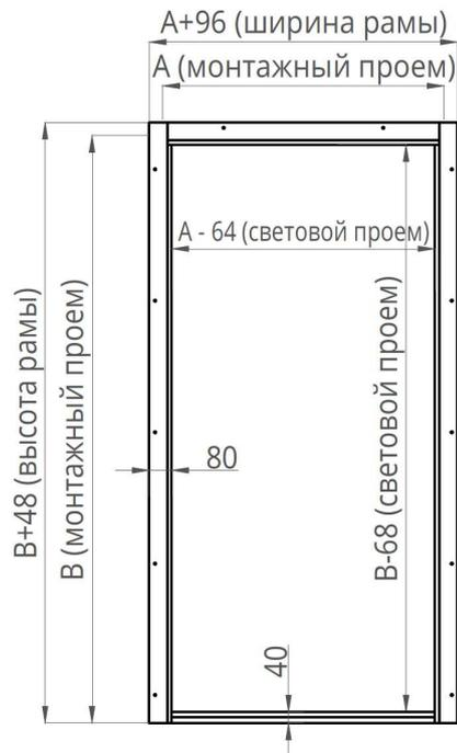
Рисунок 16. Металлическая рама в обхват, с порогом 40
