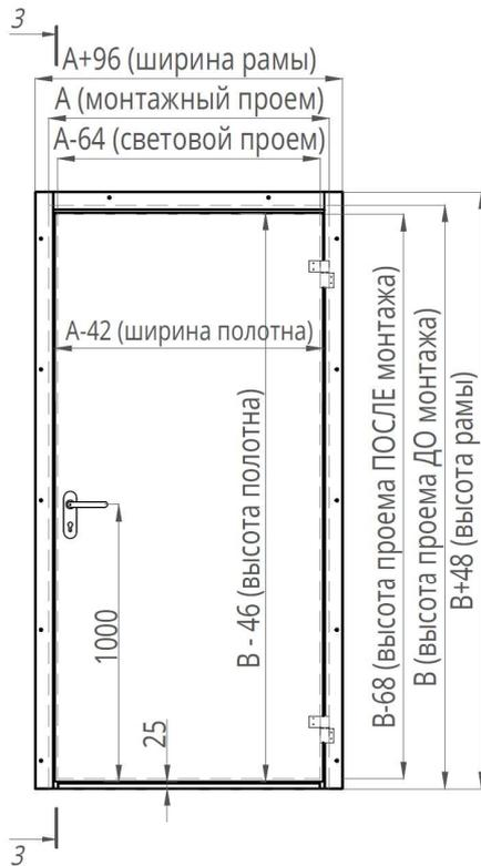
Рисунок 6. ТДО с угловой рамой с порогом 40
