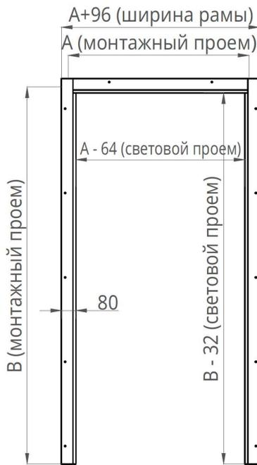
Рисунок 2. Металлическая угловая рама без порога
